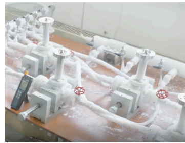
在美嘉诺工厂进行低温测试
